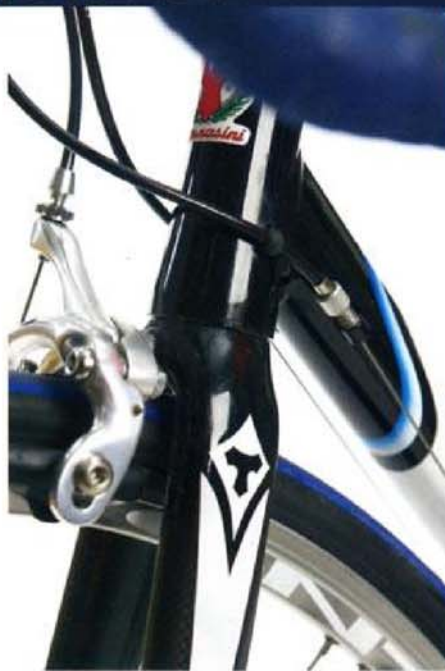
Die Veloce-Bremse liefert in Kooperation mit Campagnolo-Vento-Laufrädern eine ordentliche Verzögerungsleistung ab.
