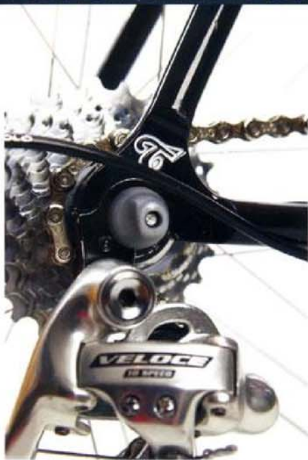
Preiswert, aber funktionell: Die Veloce-Schaltung von Campagnolo, mit zehn Ritzeln auf dem aktuellen Stand der Technik.
