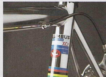
輝くチューブに張られる COLUMBUS XCr のラベル。難しいとされるステンレス溶接だが、溶接痕は細かく美しい仕上がりだ
